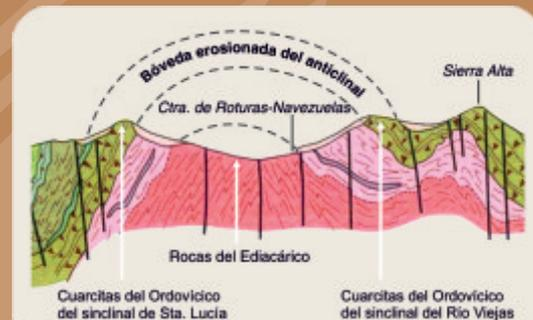
Esquema del anticlinal sobre un corte geológico del IGM
